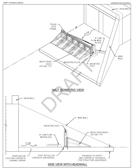
FIGURE X.XX TRASH GATE ISOMETRIC
